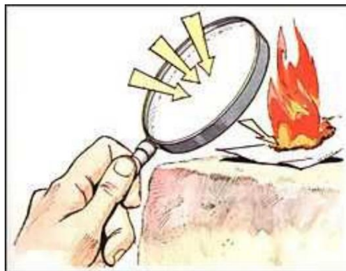
Concentratie van warmte uitgestraald door de zon, door optische procedures.
